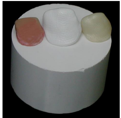
a) maquette en cire posée sur bloc en zircone crue b) chape usinée avant frittage c) la même chape après frittage Doc diadem.
