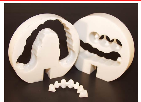
Fig ... Bridge usiné dans un bloc de zircone HIP Doc. Hint-Els.
