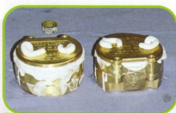
Photo 5 : coulée de la contre-partie.
