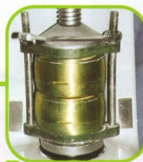
Photos 9 et 10 : mise sous bride avec contrôle de la pression.
