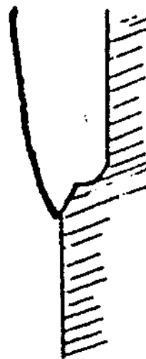
congé biseauté (chanfreiné) Métallo-céramique avec bandeau métallique En vestibulaire
